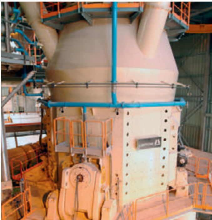
Loesche mill Type LM 46.2+2 Dunkerque, France, 2005
